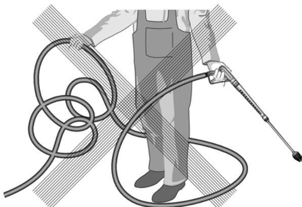
**... tendre le flexible haute pression s'il y a formation de boucles, le tirer ou le laisser frotter sur une arête vive!**
